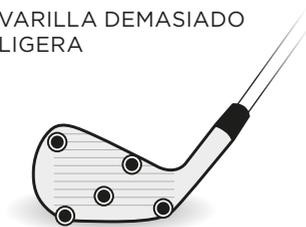
**Nota:** Cuando se realice un fitting para sets de hierros, identificar siempre la longitud y el peso adecuado de la varilla para conseguir una zona de impacto óptima. Usar una nueva pegatina de impacto en cada prueba para chequear y comparar los puntos de impacto de la bola, con el fin de establecer las especificaciones óptimas correctas.
